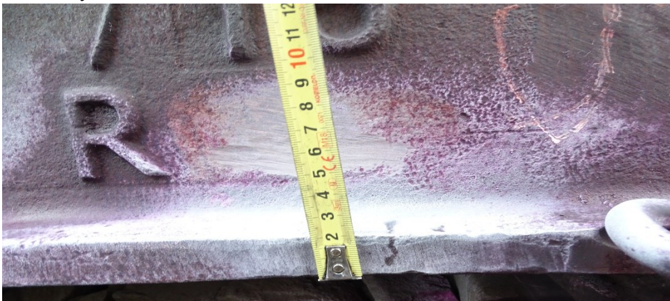
Příčné trhliny na odlitku Kód vady 724N
