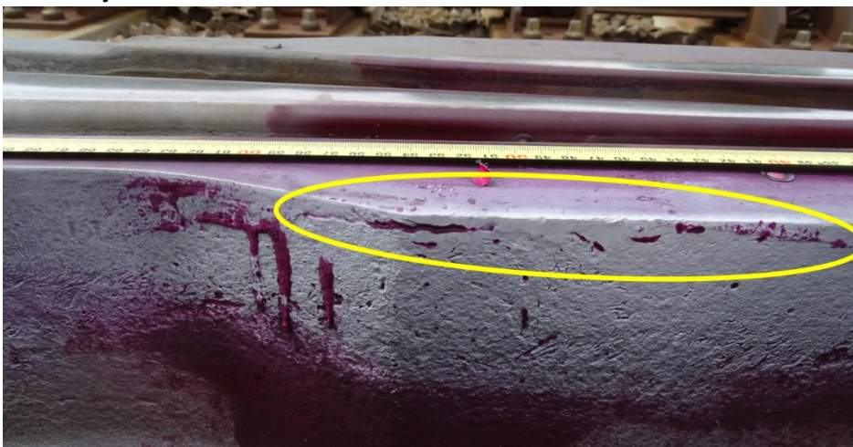
Podélné trhliny na odlitku Kód vady 624N
