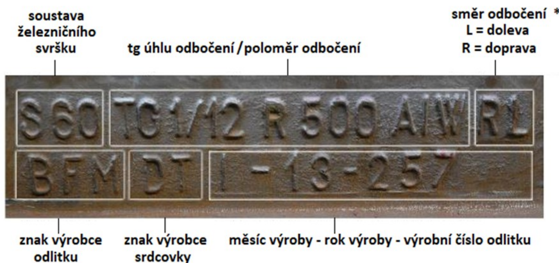
Obrázek 7 – Příklad identifikace odlitků srdcovky – BFM
