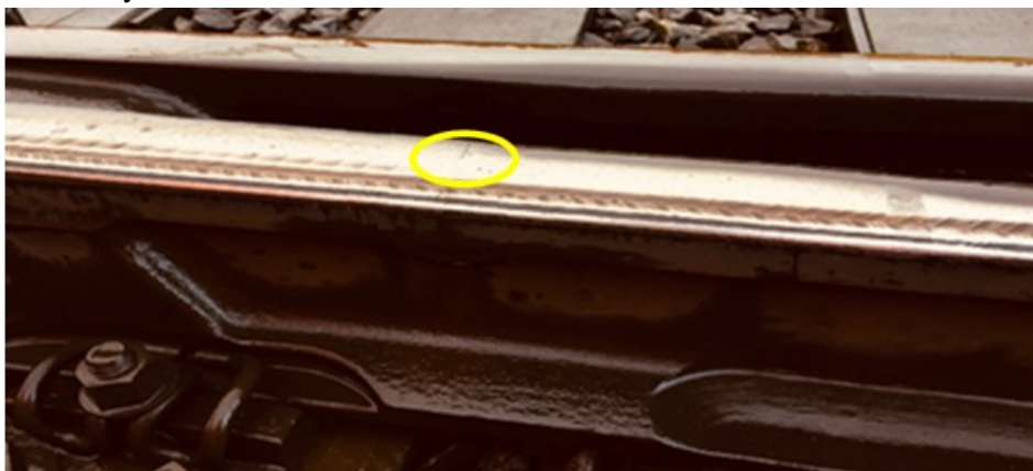
Příčné trhliny na ostatních pojížděných plochách odlitku Kód vady 722N
