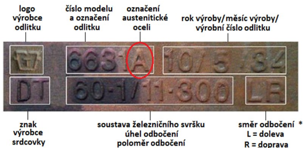
Obrázek 6 – Příklad identifikace odlitků – Slévárny Třinec
